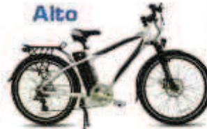
Moteur 500 W maximum - Batterie 36 Volts 10am/hr lithium manganèse à haut débit
